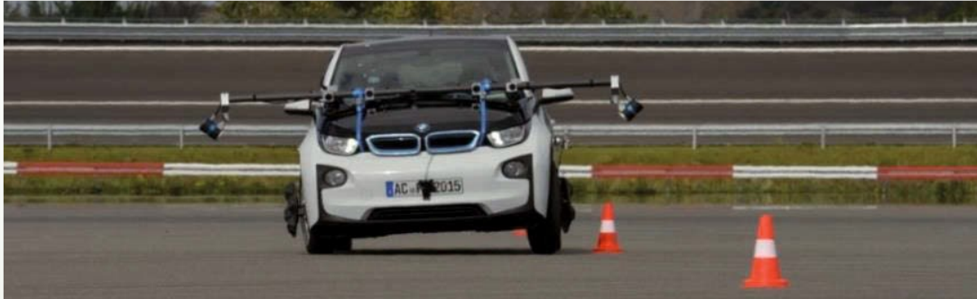
图 3:一辆装备完好的汽车进行轮胎道路实测的示例
