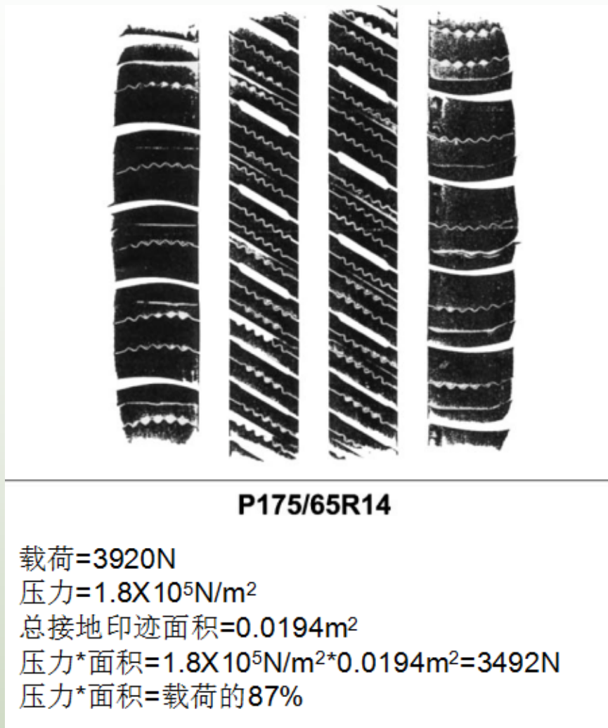
图 7 典型的充气轮胎接地印迹。请注意，总接地面积乘以充气压力相当于 87% 的轮胎负载。因此，接触压力近似等于充气压力
