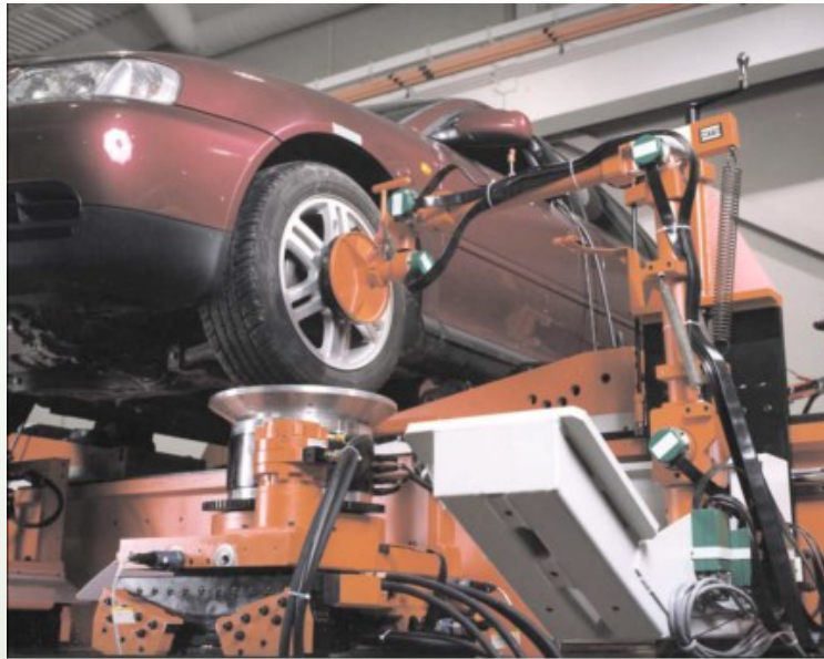
图. 1 — MTS Systems K&C. 图中所示的车辆不是本研究中使用的车辆。 Copyright © 2007 MTS Systems.
