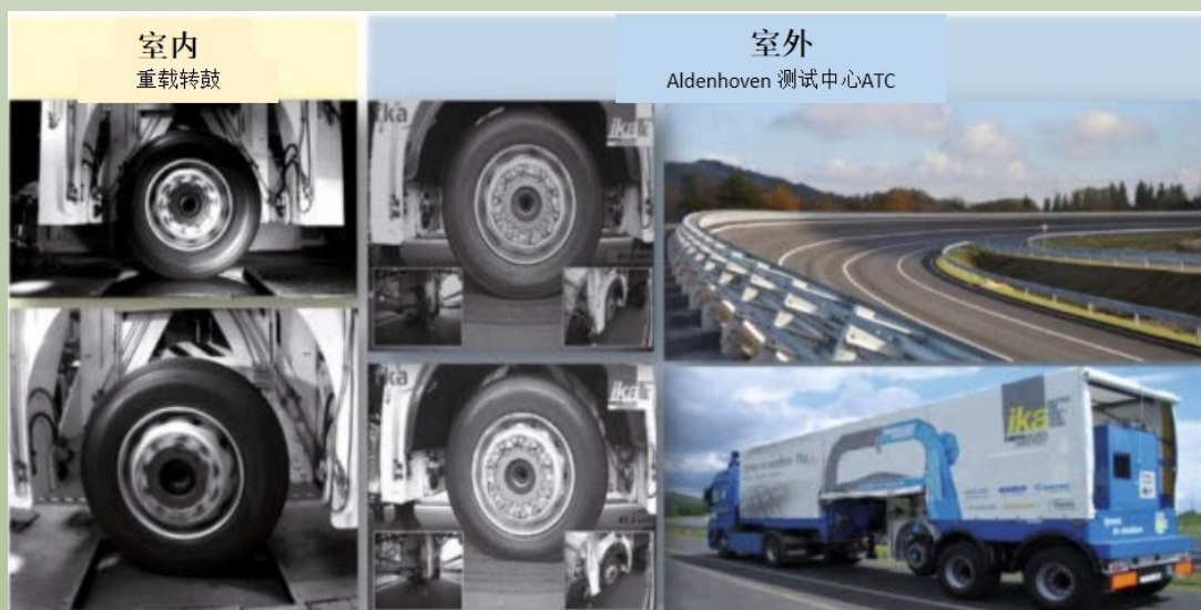
图 7 在转鼓和真实道路上的 ika/fka 移动式轮胎试验台 (FaReP)
