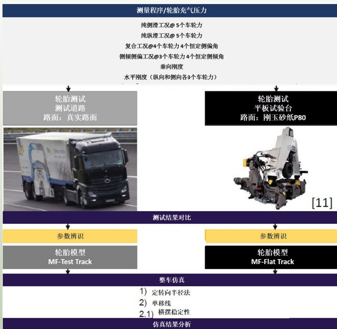
图 11:MF-Tyre 参数辨识和侧向性能评价车辆动态操纵测试流程
