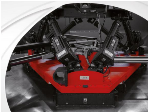
图 2 DIM 驾驶模拟器使用电缸驱动
